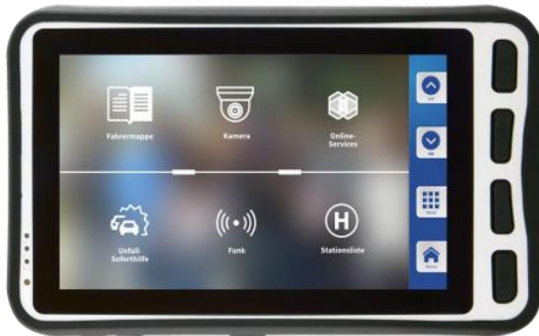
Ausgewählte Daten des internen (Betriebsführung) System werden über eine GPRS-Verbindung permanent mit den Inhalten der Telematik-Box abgeglichen. Ein integriertes GPS-Modul ermöglicht darüber hinaus die Lokalisierung des aktuellen Fahrzeug-Standortes. Somit lassen sich Verkehr, Ankunftszeiten, Umleitungen oder positionsbezogene Informationen für Fahrgäste differenziert auf den installierten Displays ausgeben.
